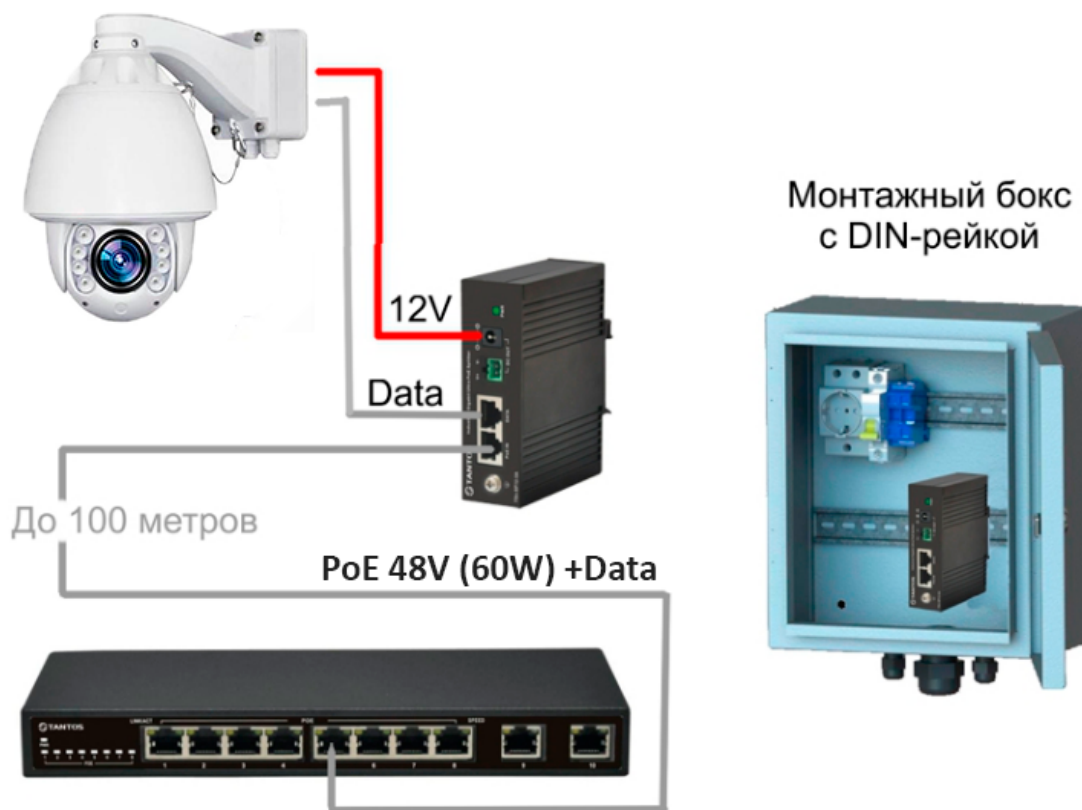
Рисунок 2 - Схема подключения видекамеры с помощью сплиттера
