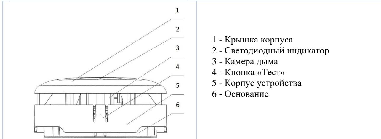
Рисунок 1 – Внешний вид извещателя (вид спереди)
