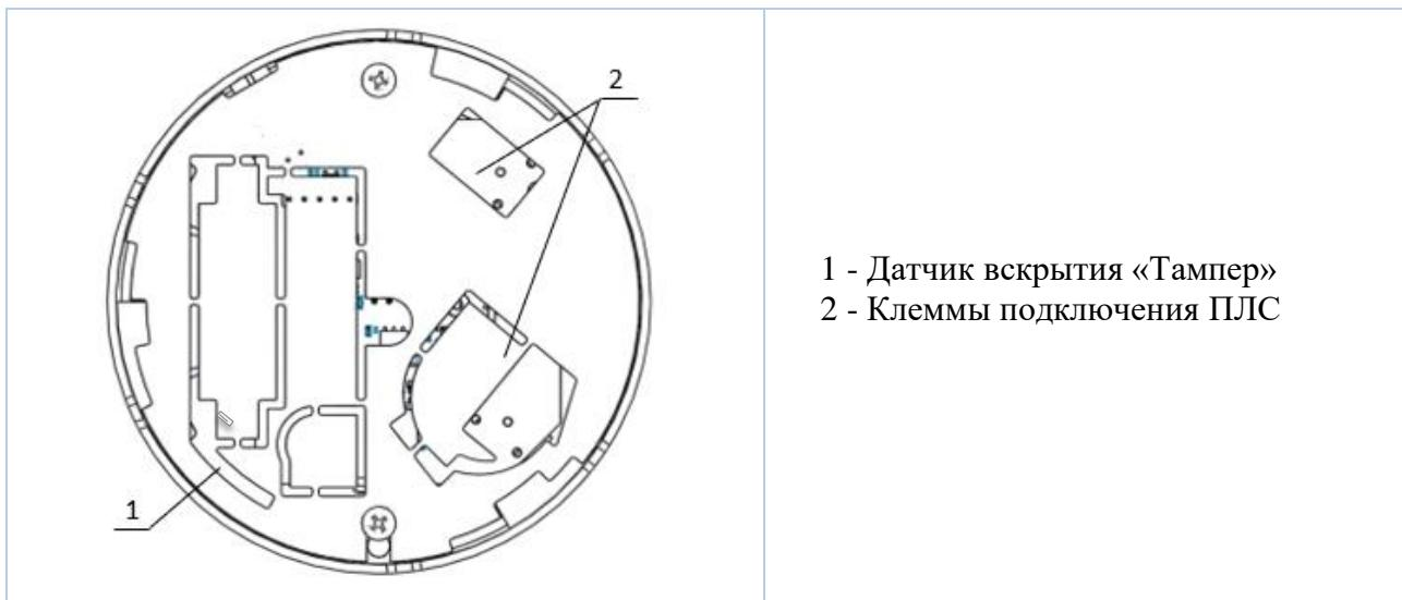
Рисунок 3 – Внутреннее устройство извещателя
