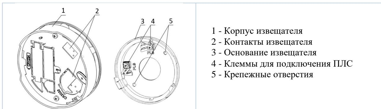
Рисунок 2 – Внешний вид извещателя (вид сзади)
