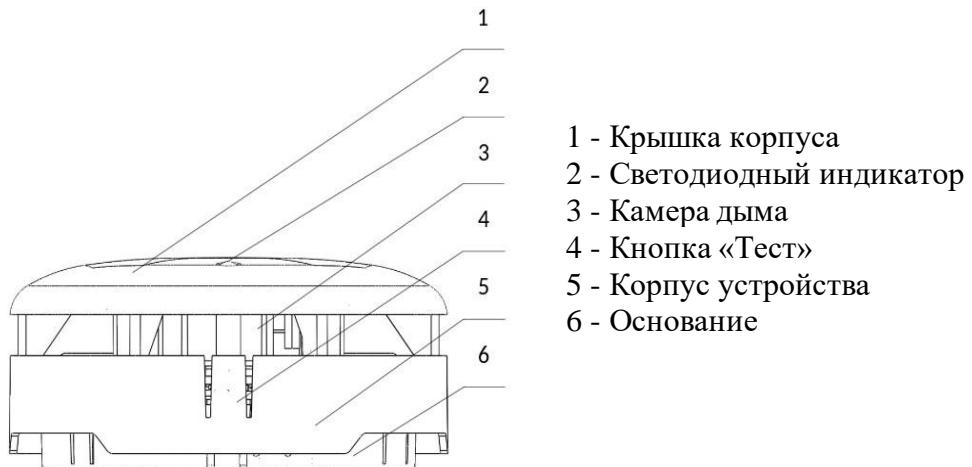
Рисунок 1 – Внешний вид извещателя (вид сбоку)
