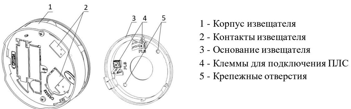
Рисунок 2 – Внешний вид извещателя (вид сзади)
