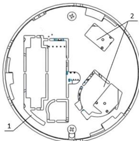
1 – Датчик вскрытия «Тампер»
