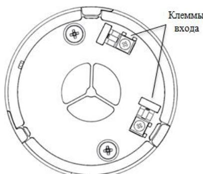
**ВАЖНО!** Установку извещателя на основание проводить только после перевода ППК в режим поиска доступных устройств (см. п 2.4).
