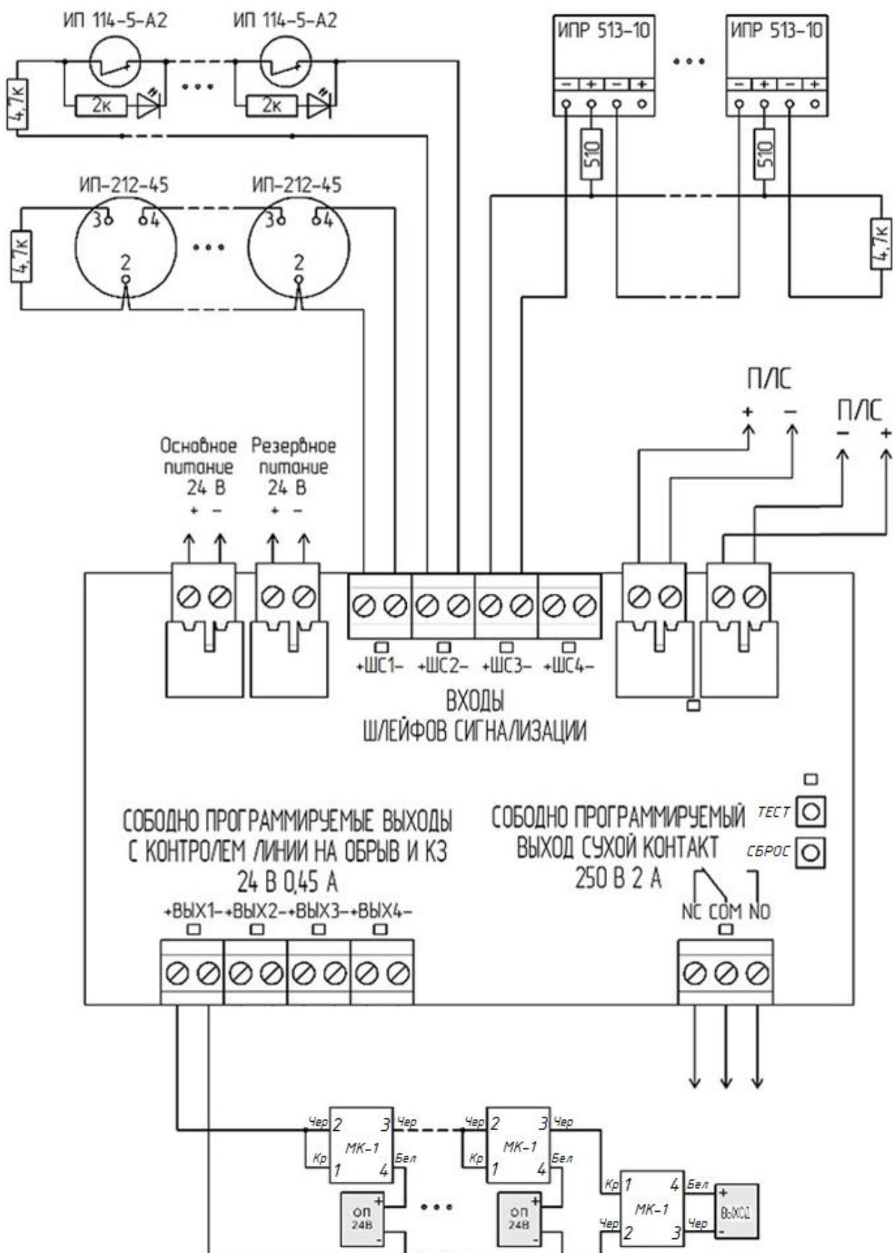
Рисунок 3 - Общая схема внешний подключений
