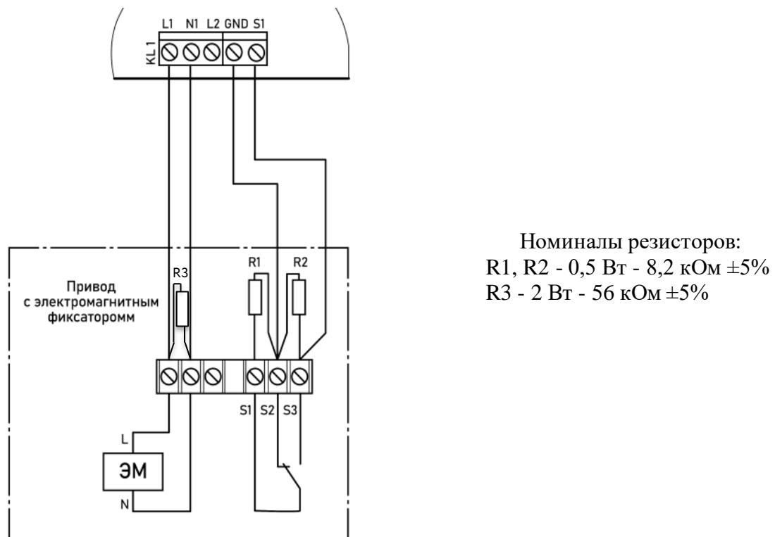
Рисунок 8 - Схема подключения привода с электромагнитным фиксатором
