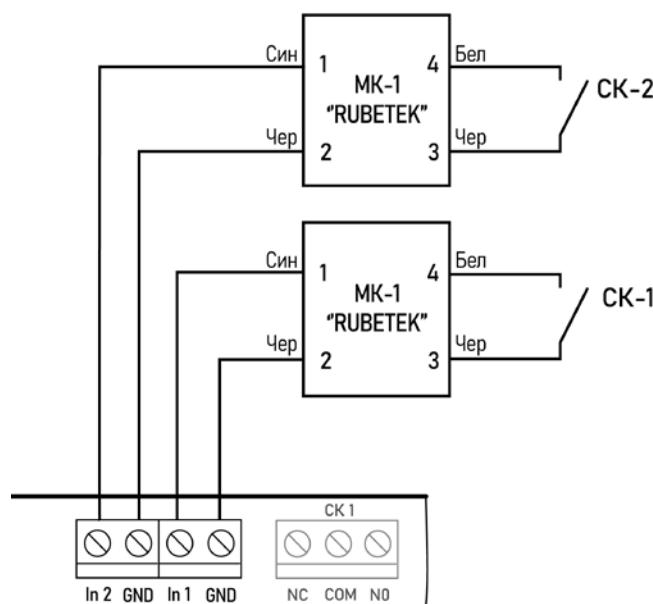
Рисунок 13 - Схема подключения свободно программируемых входов
