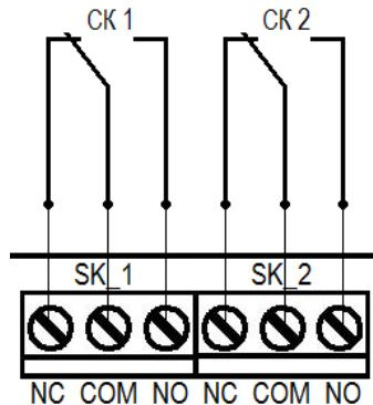
Рисунок 12 - Схема подключения к СК прибора
