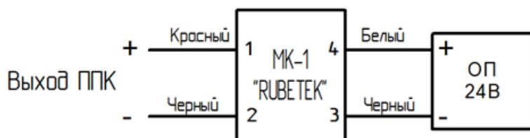
Рисунок 11 - Схема подключения MK-1 к ОП
