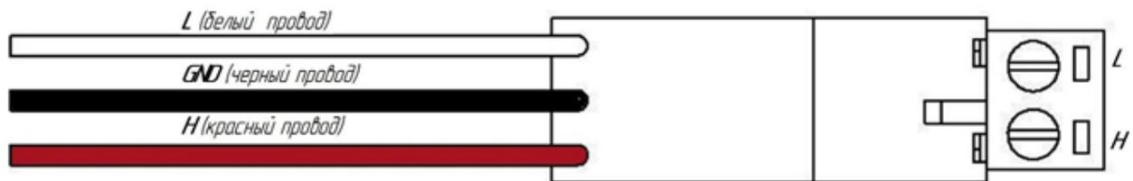
Рисунок 3 - Маркировка контактов модуля
