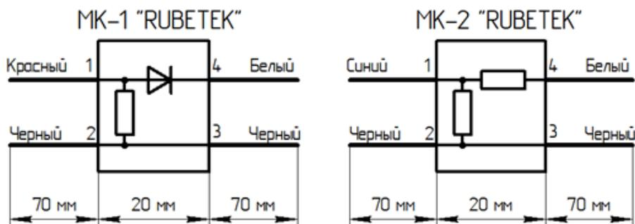
Рисунок 3 - Схема модулей
