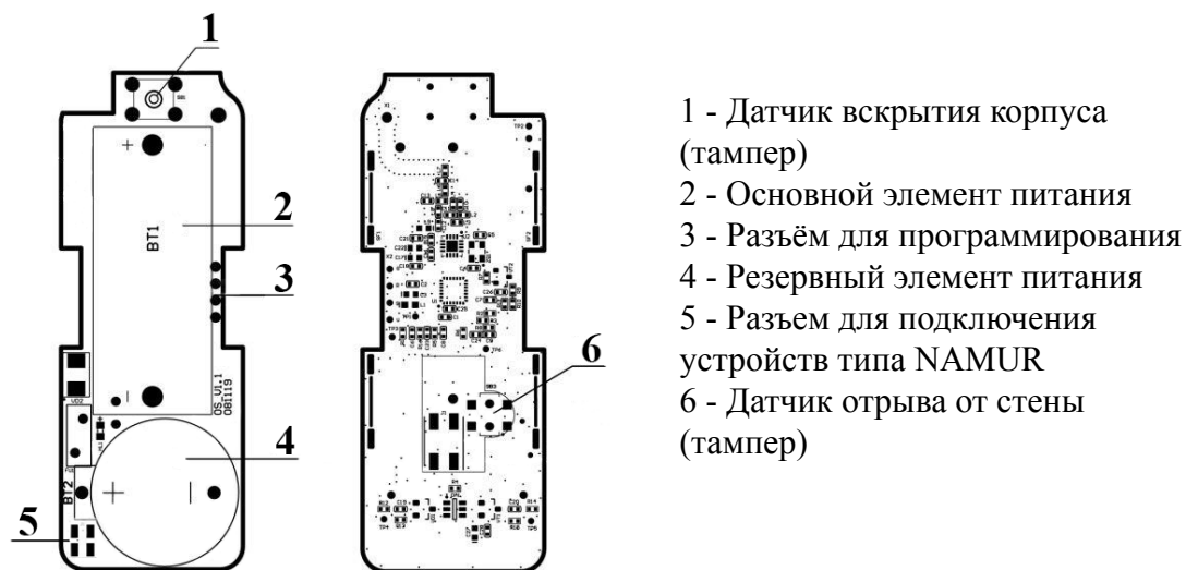
Рисунок 2 - Внутреннее устройство датчика
