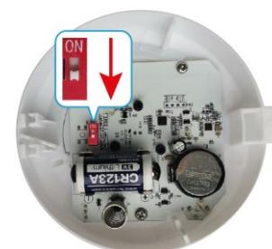
**ВНИМАНИЕ!** Мощность извещателя в режиме программирования снижена. **ВАЖНО:** перевести переключатель **ПРОГ** в состояние **OFF** после привязки устройства.
